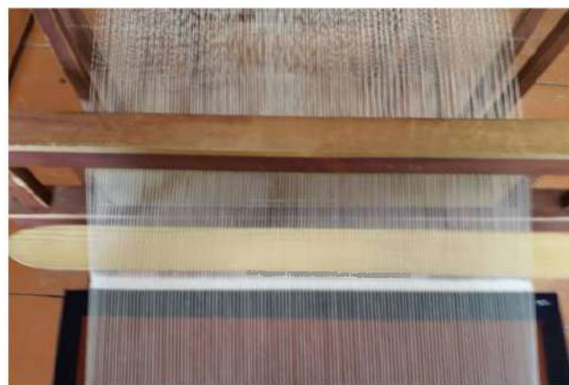
Начало работы. Временное закрепление края будущего полотенца
