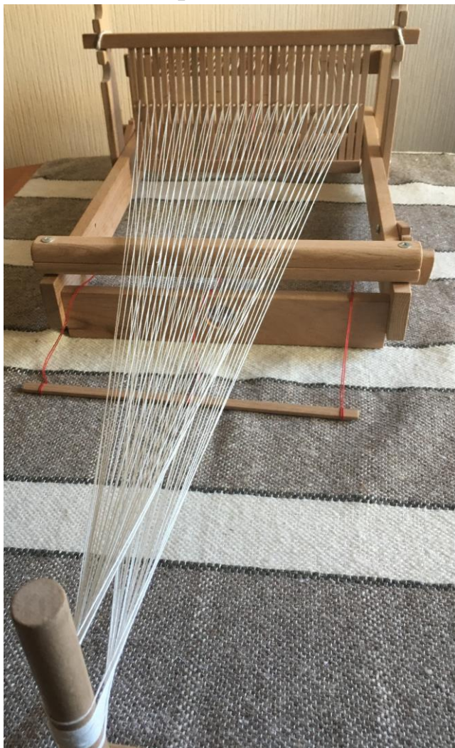
Фото 2. Изображена основа в натянутом виде между станком и струбциной.
